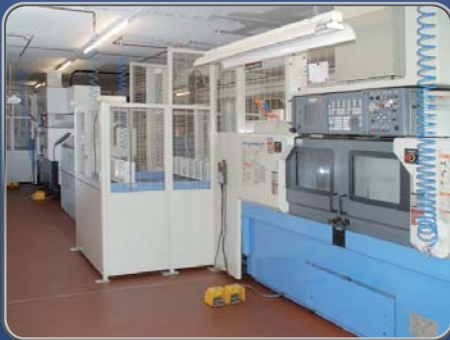
Vollautomatische 8-Achsen CNC-Maschinen. Full automatic 8-axle CNC-Machines.
