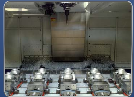
Bearbeiten von Antriebsteilen für EA -Stoffschieber. Machinery of actuator parts for EA -knife gate valve.
