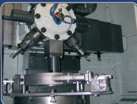
Bearbeiten von bis zu 180kg schweren und 1.000mm großen Gehäusen für EA -Stoffschieber. Machinery of bodies for EA -knife gate valve up to 180kg and 1.000mm length.
