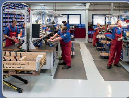
Montage der EA -Antriebe auf Kugelhähne oder Absperrklappen. Assembly of the EA -actuators with ball valves or butterfly valves.
