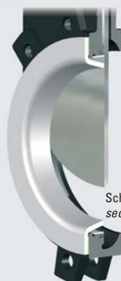
Kegelblende für abrasive Medien, um das Medium in den Mittel- strom zu lenken. / Deflector for abrasive media to deflect the media into the main stream.
