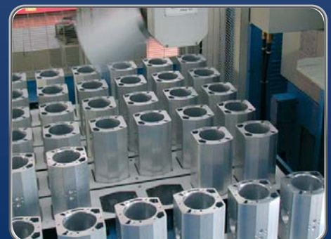
Ein Beladeroboter legt fertig bearbeitete Gehäuse auf einem Palettensystem ab. A handling robot placed ready machined bodies onto a storage system.
