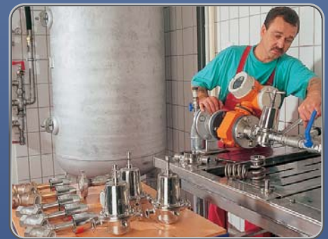
Messen der Durchflussleistung eines Druckminderers. Measuring of the flow rate of a pressure reducer.
