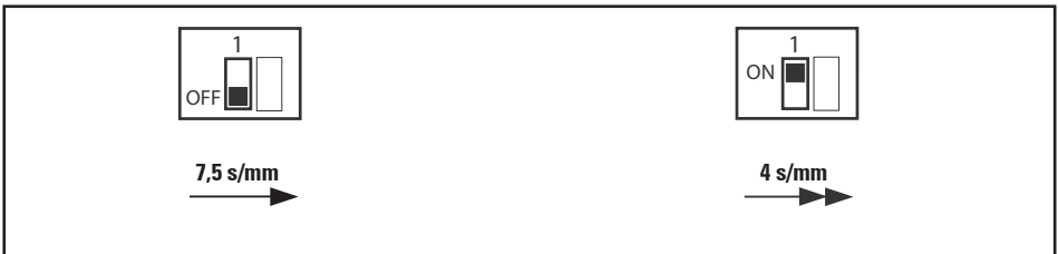
Abb. 6.8 - Einstellung der DIP-Schalter: Schalter S1.1
