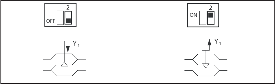
Abb. 6.9 - Einstellung der DIP-Schalter: Schalter S1.2
