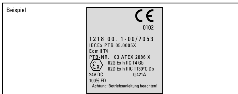
Abb. 4.2 - Zusätzliches Typenschild für explosionsgeschützte Magnetventile
