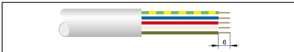
Abb. 6.4 - Einbau, Abisolieren der Kabel / Leitungen
