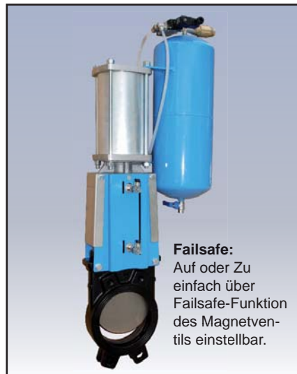
Bild 2: Pneumatisch betätigter Stoffschieber mit Drucklufttank mit Sicherheitsfunktion. Als Alternative zu federrückstellenden pneum. Antrieben, die problematisch zu warten sind (Federvorspannung) und deren Failsafe-Position nicht umgestellt werden kann.
